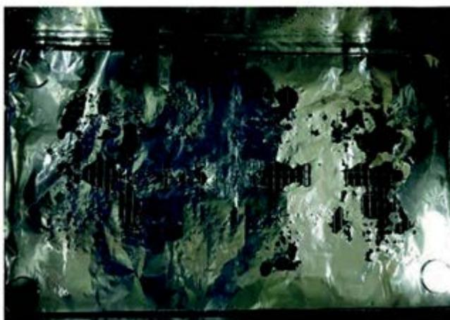
Рисунок Е.3 — Алюминиевая фольга после проверки работоспособности ультразвуковой ванны
